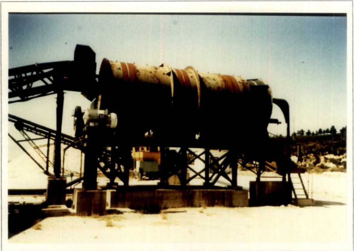
Fotografia-4: Tromel de lavado de tamaños para ferroaleaciones
