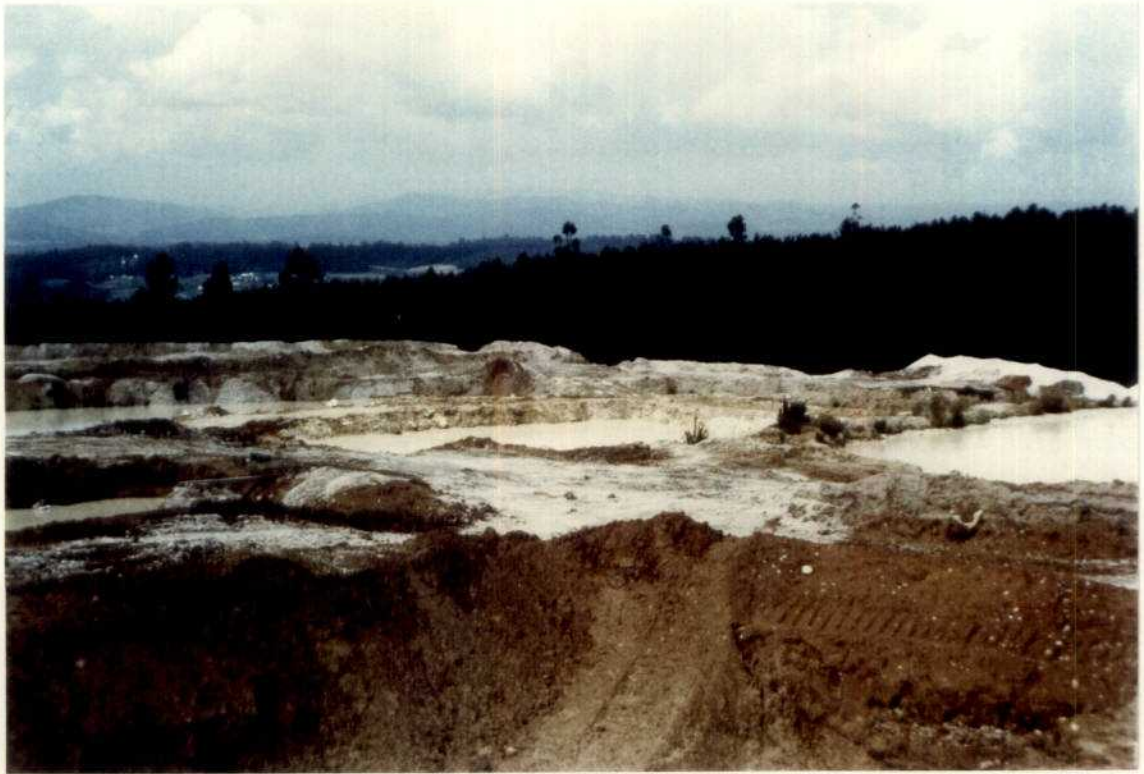
Fotografía-9: Balsas de decantación
